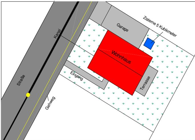
Dachfläche: aus Ziegel, 12 x 10 m = 120 m<sup>2</sup>, an Kanal angeschlossen !
